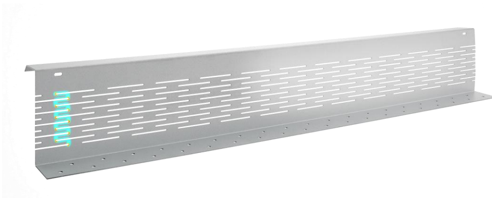
Mehrere Reihen Langlöcher in versetzter Anordnung leiten den Wärmestrom um und sorgen für eine reduzierte Wärmebrückenwirkung. Foto: Zambelli GmbH & Co. KG
