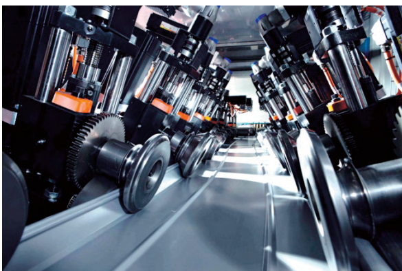
Bild 1: Profiliervorgang am Beispiel eines Falzprofils
