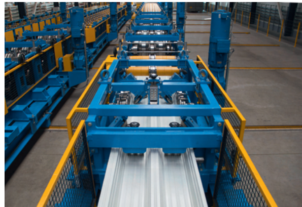
Bild 1: Profiliervorgang am Beispiel eines Trapezprofils
